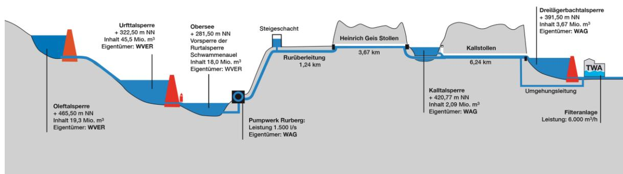
Abb. 7: Talsperrenverbundsystem
