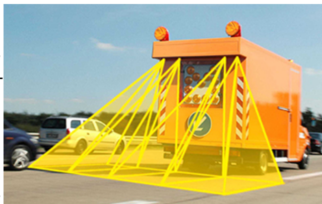
Messfahrzeug MESOB (Substanzmerkmale - Oberfläche)
