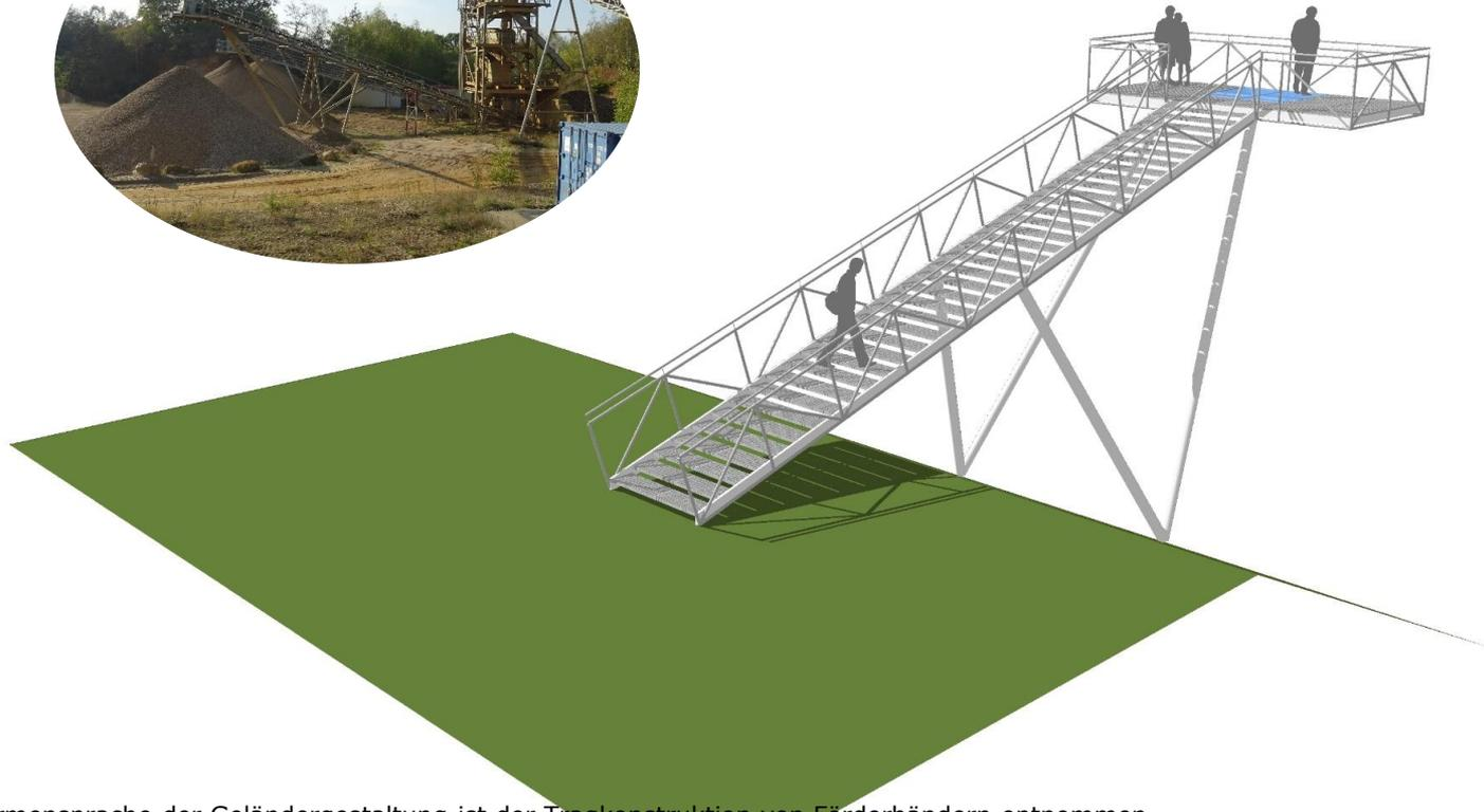
Die Formensprache der Geländergestaltung ist der Tragkonstruktion von Förderbändern entnommen
