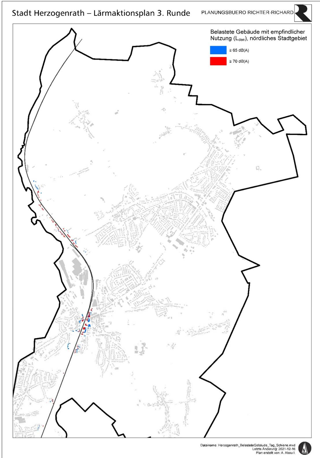
Abb. 5.17: Schienenverkehr: Belastete Gebäude mit empfindlicher Nutzung  $L_{den}$  [VBEB], nördliches Stadtgebiet
