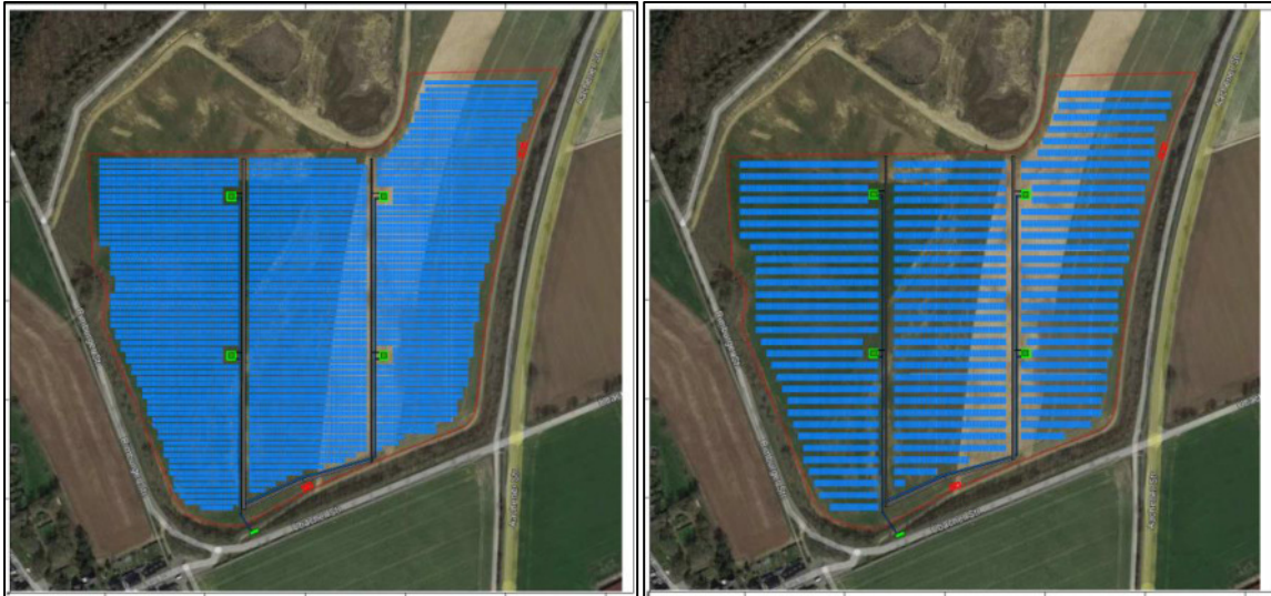
Abb. 8: Zwei Aufstellungsvarianten des Solarparks mit intensiver PV-Planung (links) und extensiver Variante (rechts) (Quelle: STAWAG Energie GmbH).
